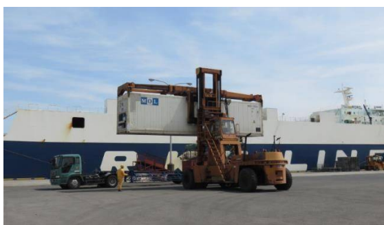
【現行トップリフターでの船側荷役風景】
