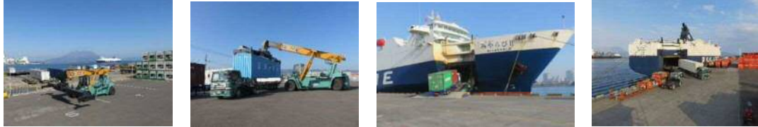
【鹿児島港国際コンテナヤードでの荷役風景】 【ランプウェイ荷役 (船内へシャーシで船積み)】
