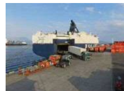
【ランプウェイ荷役（船内ヘシャーシで船積み）】
